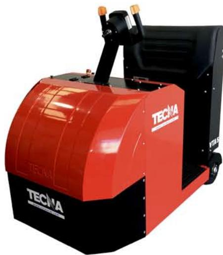
***"Sistema anti-vuelco ACS ® (Automatic Collapsible System) desarrollado por Tecnacar para una reducción automática de velocidad en curvas."***
