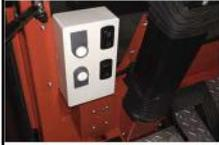
Contrôle des Instruments du système hydraulique et électrique accessible depuis la cabine
