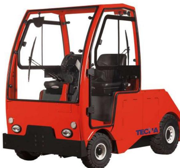
***“Le toit de protection et la cabine sont sur amortisseurs hydrauliques qui permettent le meilleur confort de conduite, en éliminant vibrations et en diminuant le niveau sonore”***
